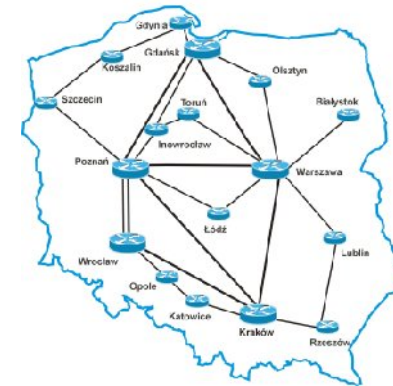
Sieć IP-MPLS Telekomunikacji Kolejowej Sp. z o.o.
