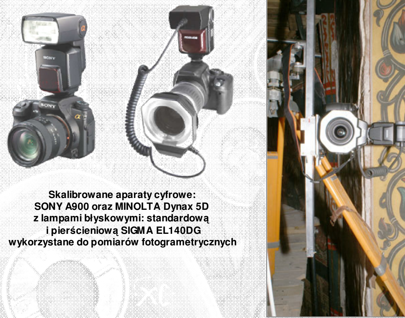
Mechaniczna pionowa baza fotogrametryczna z aparatem SONY A900 i lampą SIGMA EL140DG
