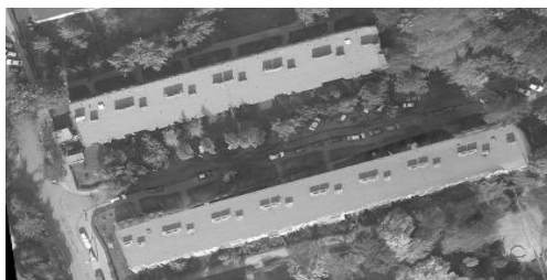
Rys. 2. Fragment ortofotomapy, dla której wykorzystano do ortorektyfikacji NMPT z wszystkich punktów skaningu laserowego o gęstości 16pkt/m 2 .
