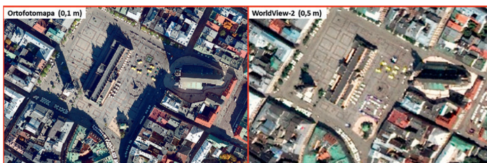
Ryc. 1.18. Porównanie rozdzielczości obrazów: ortofotomapa GSD 10 cm (MSIP Kraków), WorldView-2 © 2018 European Space Imaging GSD 0,5 m ( pan-sharpening ) (źródło: ProGea 4D, 2020)
