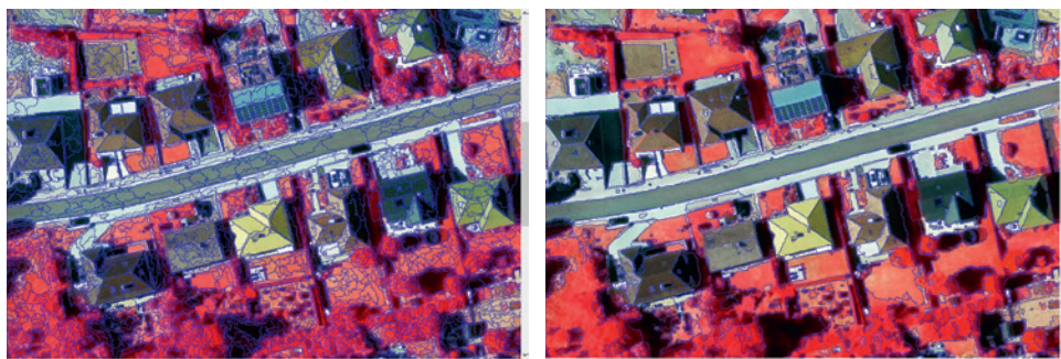
Ryc. 5.27. Przykład segmentacji (Multiresolution Segmentation) z zastosowaniem różnych parametrów (shape; compactness) w celu wyodrębnienia budynków (źródło: Zięba-Kulawik i in. 2020)
