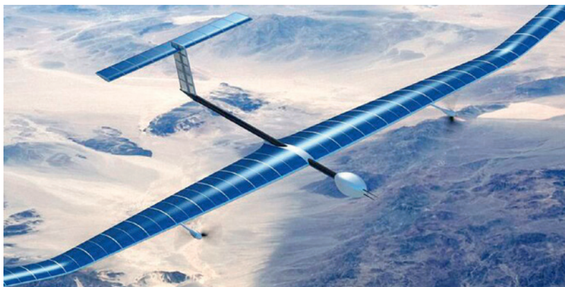
Ryc. 7.7. Pseudosatelita Zephyr-S HAPS napędzany energią słoneczną (źródło: Airbus, 2020)
