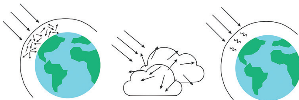
Ryc. 1.10. Interakcja PEM z atmosferą: rozproszenie, rozproszenie nieselektywne, absorpcja (źródło: NRCAN, 2019)
