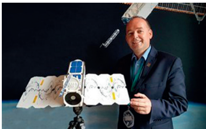
Ryc. 7.2. Nanosatelita PlanetScope Dove (pol. Gołębica) o wymiarach 30 \times 10 \times 10 cm (tzw. 3U CubeSat; fot. P. Wężyk)
