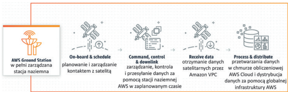
Ryc. 4.15. Schemat działania AWS Ground Station (źródło: za Amazon AWS, 2020)
