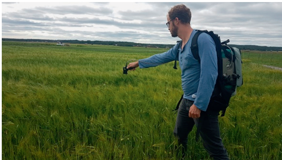
Ryc. 1.40. Naziemne pomiary spektralne uprawy jęczmienia z wykorzystaniem spektrometru FieldSpec4 (źródło: Fieldsites, 2020; fot. Uttam Kumar)
