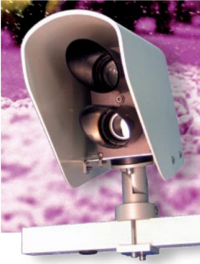
Laserowy, bezinwazyjny czujnik stanu nawierzchni- DSC111
