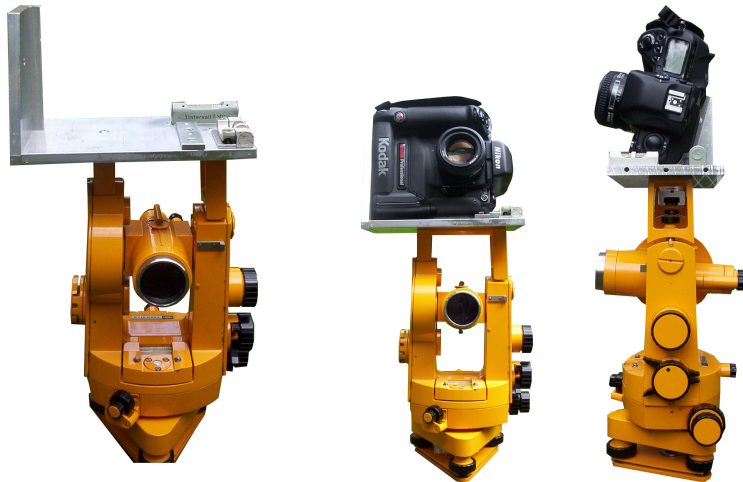
Urządzenie mocujące zamocowane na teodolicie
