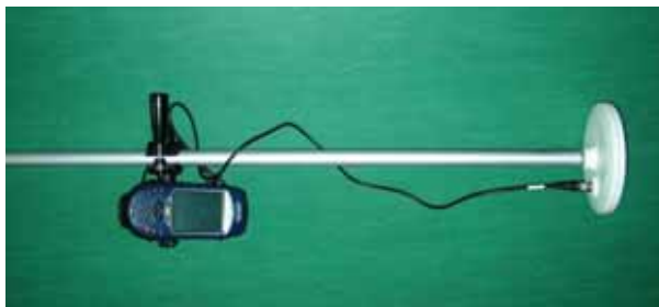
Rys. 2. Mobile Mapper CX z anteną zewnętrzną
