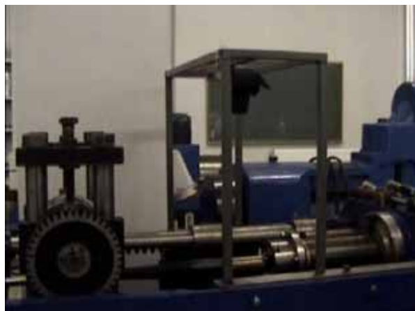
Rys. 5. Urządzenie do wykonywania zdjęć przymocowane do walcarki pielgrzymowej (fot. J. Osika, 2008).
