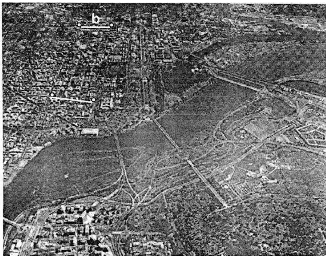
Rys. 5. Zniekształcenia skali na zdjęciu ukośnym, (por. rys. 10) (według [8])
